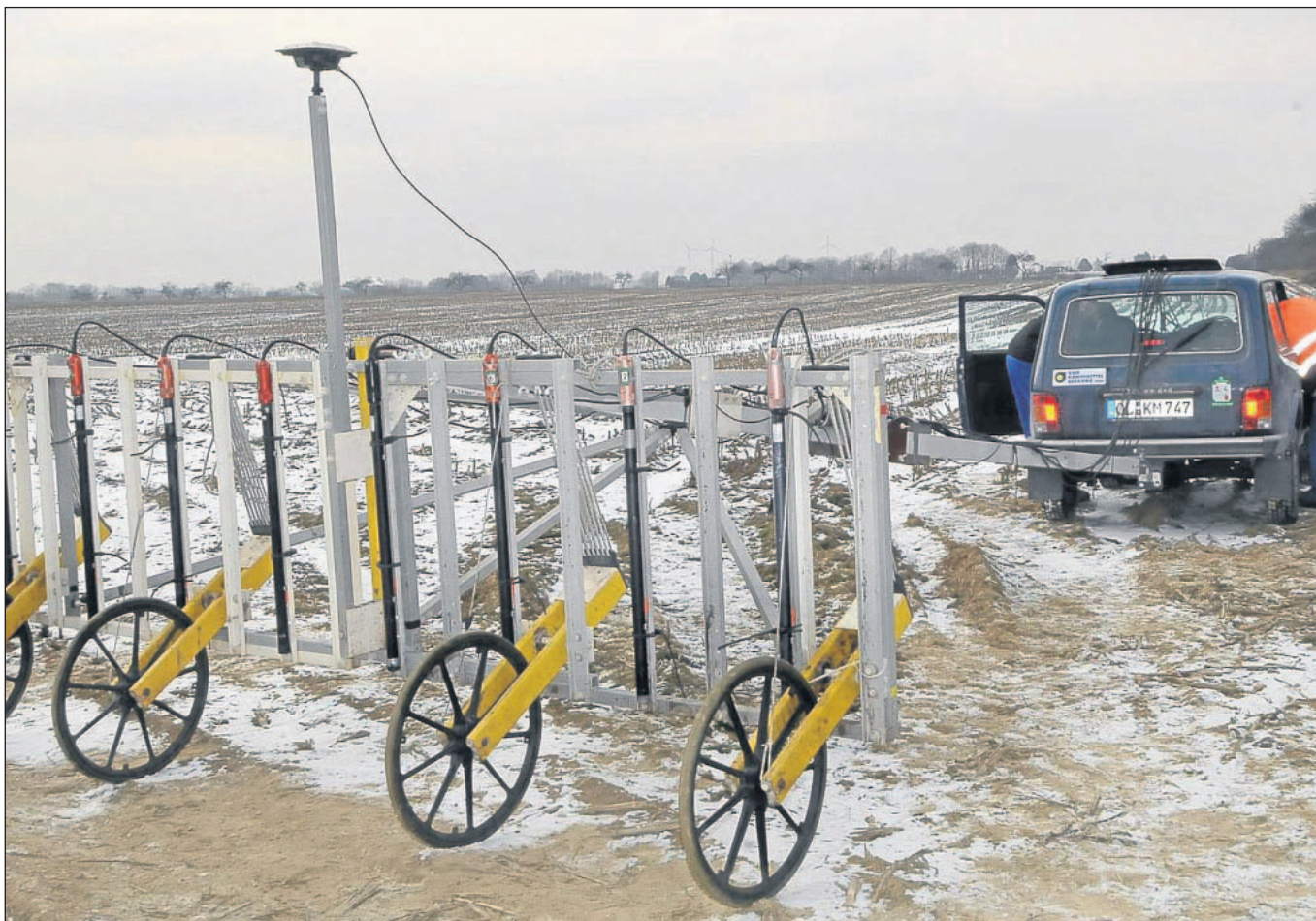
Wie eine moderne Egge sieht der Magnetometer-Wagen aus, der zurzeit über die Felder am Ardey ruckelt. ■ Foto: Niggemeier
